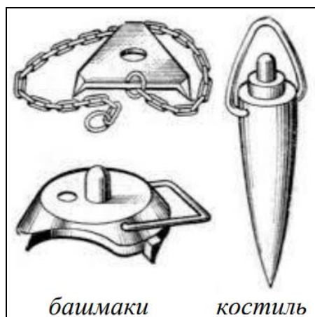
Рисунок 4.9 – Спеціальні переносні опори для нівелірних рейок (башмаки та костиль)
