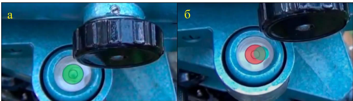
Рисунок 2.12 – Результати перевірки круглого рівня нівеліра: а – умова виконана; б – умова не виконана
