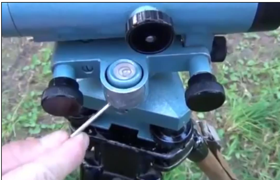
Рисунок 2.13 – Виправлення круглого рівня за допомогою шпильки
