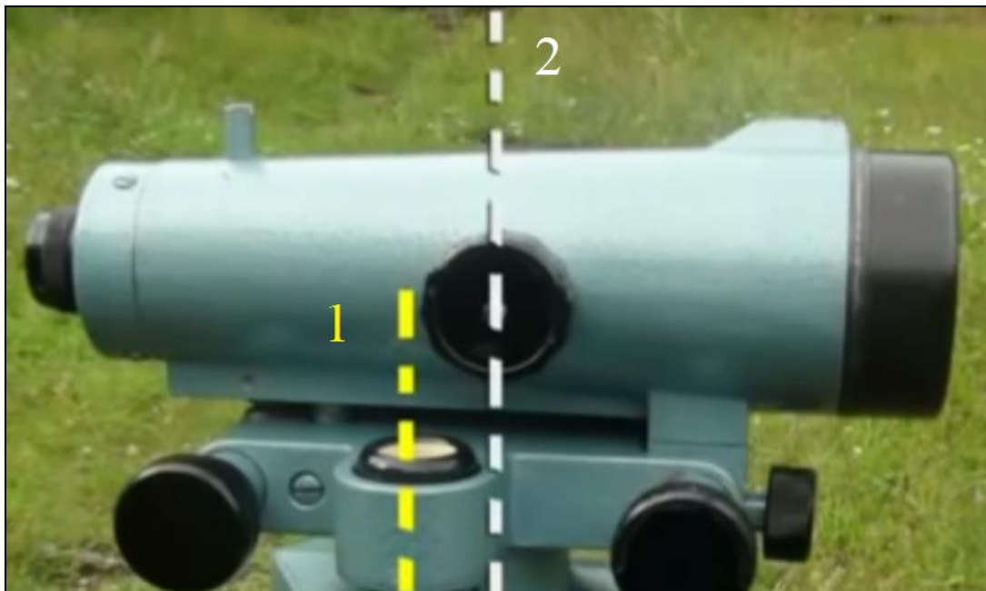
Рисунок 2.10 – Перевірка паралельності осі круглого (сферичного) рівня до осі обертання нівеліра: 1 – вісь круглого рівня; 2 – вісь обертання нівеліра
