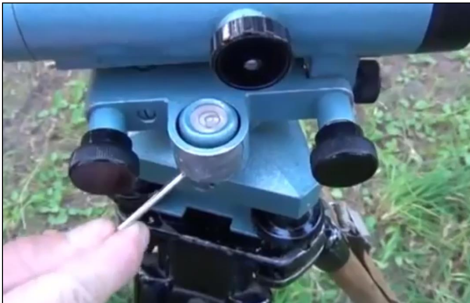
Рис. 3.5 – Виправлення (юстування) круглого рівня за допомогою шпильки
