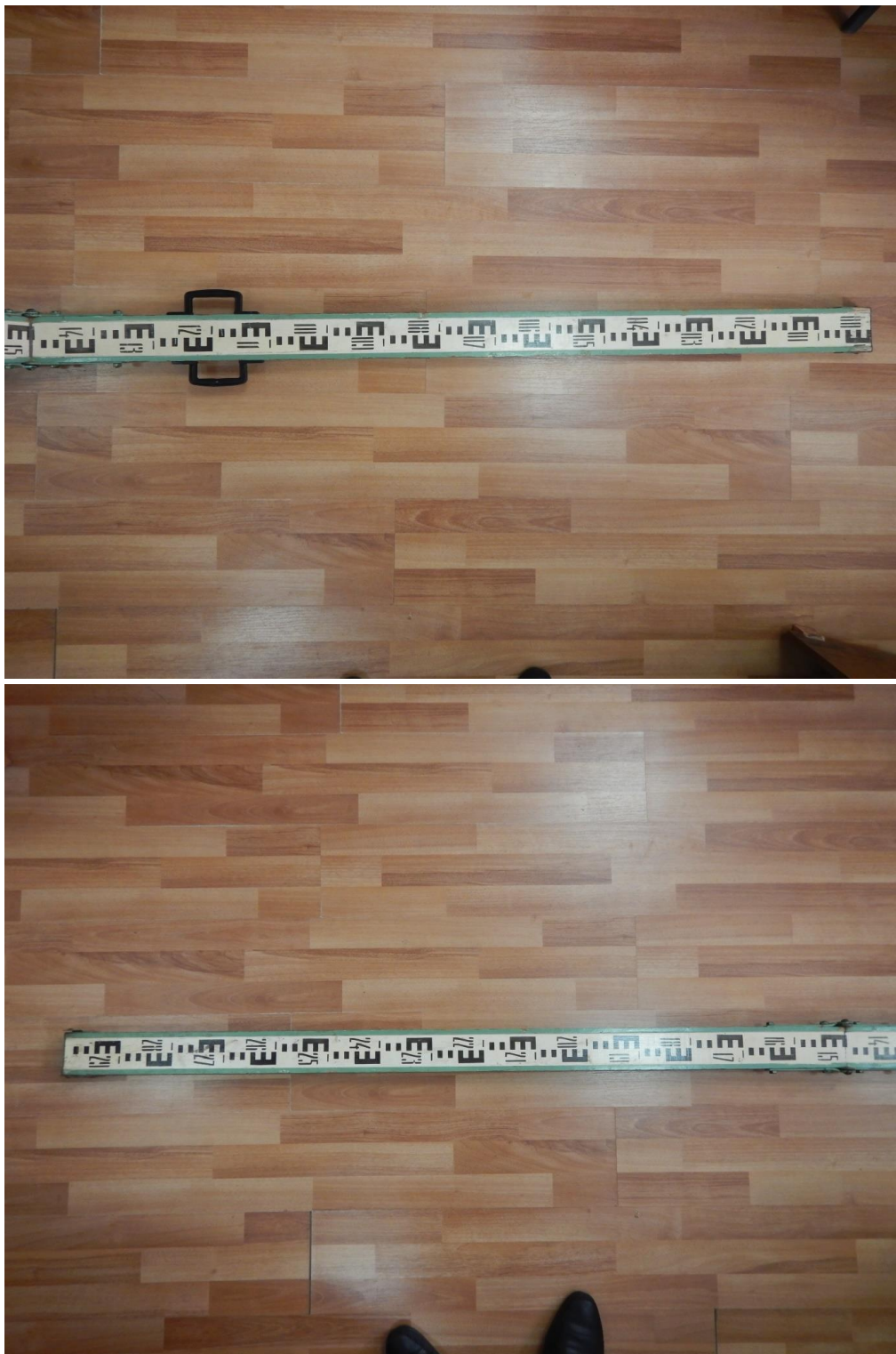
Рис. Г.6 – Вихідні дані до виконання перевірки № 1 ( чорна сторона): відповідність шкал і написів поділів типу рейки та інші етапи огляду (варіанти № 1, 3, 5)
