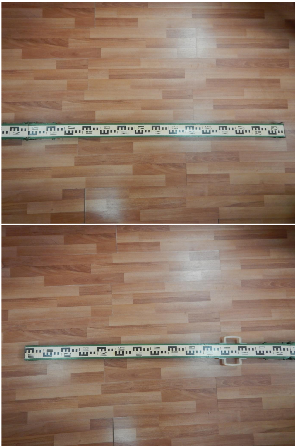
Рис. Г.11 – Вихідні дані до виконання перевірки № 1 ( чорна сторона): відповідність шкал і написів поділів типу рейки та інші етапи огляду (варіанти № 2, 4)
