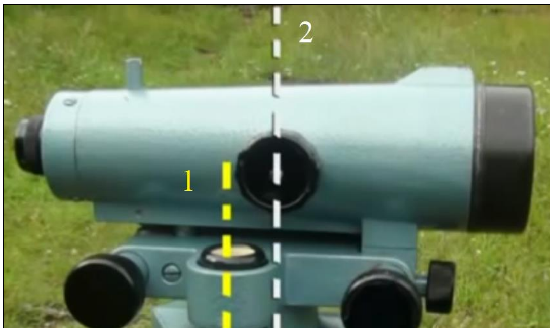
Рис. 3.2 – Перевірка паралельності осі круглого (сферичного) рівня до осі обертання нівеліра: 1 – вісь круглого рівня; 2 – вісь обертання нівеліра
