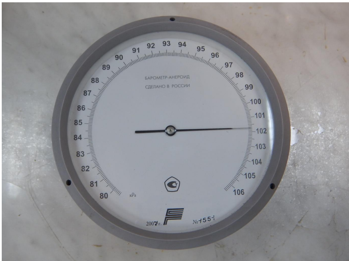
Рис. А.13 – Фото барометра-анероида для визначення атмосферного тиску під час компарування (див. Приклад до лабораторної роботи № 1)
