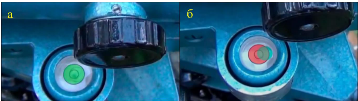
Рис. 3.4 – Результати перевірки круглого рівня нівеліра: а – умова виконана; б – умова не виконана
