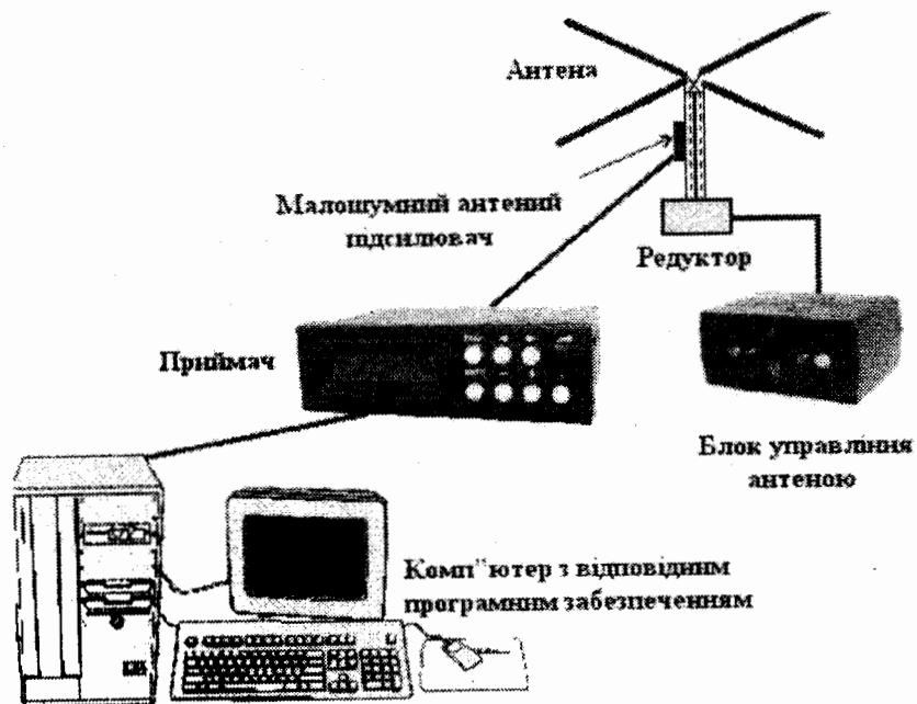
Рис.6.1 – Склад станції прийому супутникової інформації КОСМЕК
