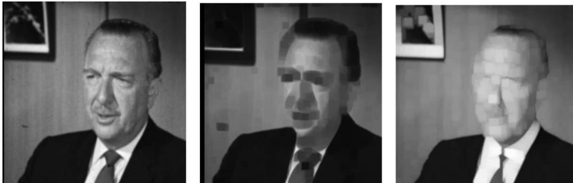
Рисунок 7.12 – Вихідне зображення із прикладами ерозії (у центрі) і дилатації (праворуч) плоским структурним елементом квадратної форми
