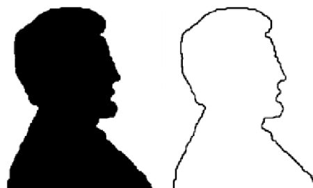
Рисунок 7.10 – Приклад морфологічного виділення границі бінарного об'єкта
