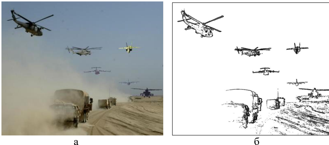
Рисунок 8.3 – Приклад виконання бінаризації: а) вихідне кольорове зображення; б) бінарне зображення, отримане з вихідного вищеописаним методом
