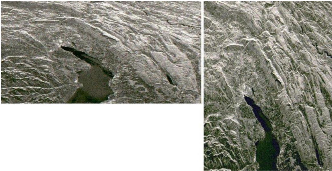
Рисунок 3.28 – Перекручування похилої дальності міняє пропорції об'єктів (праворуч реальні пропорції)
