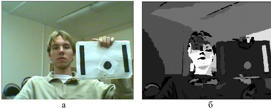
Рисунок 9.2 – Вихідне зображення (а) і результат його сегментації (б) при \delta=50
