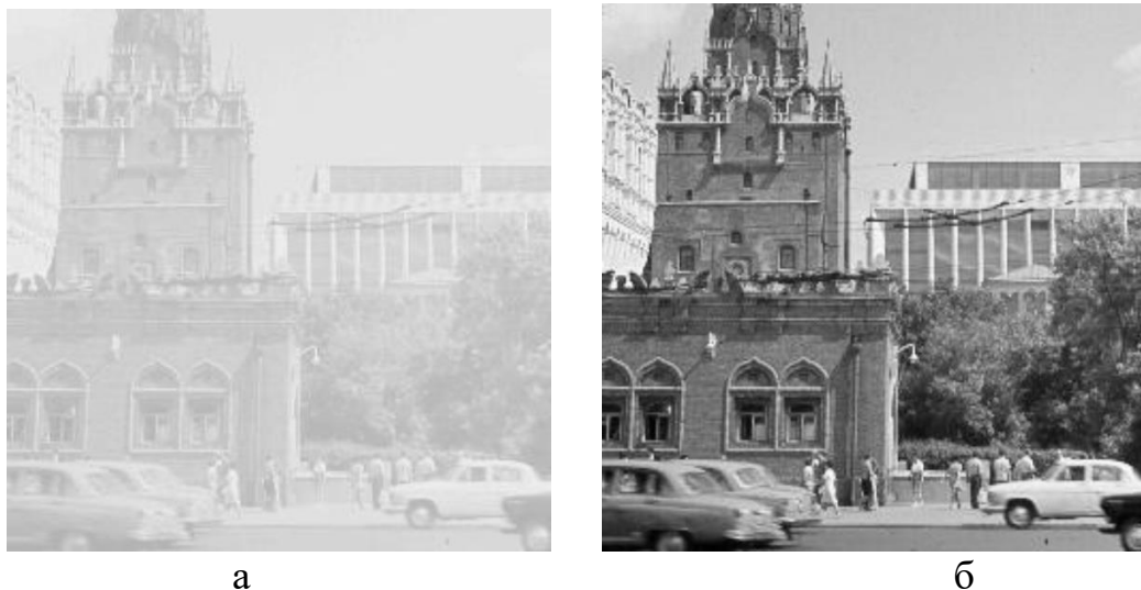
Рисунок 5.7 – Світле зображення (а) з діапазоном яскравості x_{min} = 180 , x_{max} = 240 перетвориться за допомогою лінійного розтягання контрасту (б)
