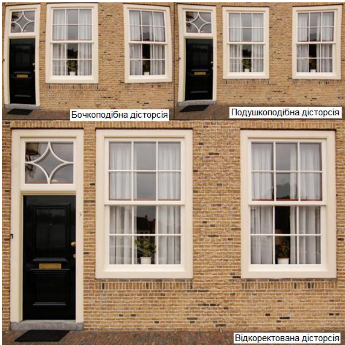
Рисунок 4.16 – Приклади двох видів дісторсії й виправлене зображення
