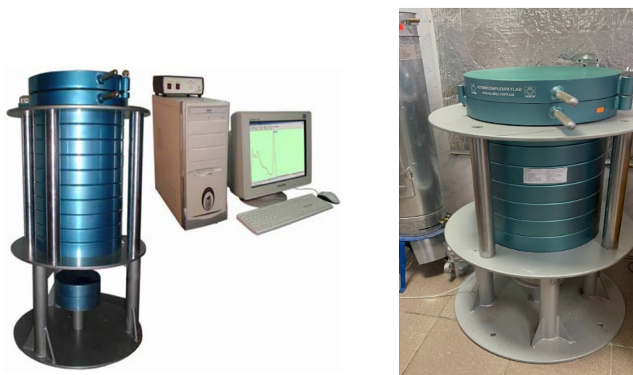
Рис 5.5 - Гамма спектрометр енергії - випромінювання сцинтиляційний
