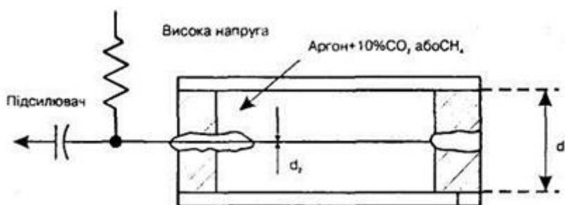
Рис. 4.3 – Схема пропорційного лічильника
