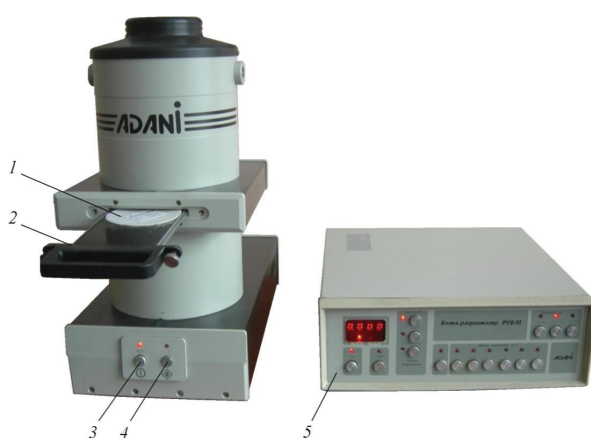
Рис.5.3 - Загальний вигляд бета-радіометра РУБ-91 «АДАНИ»:
