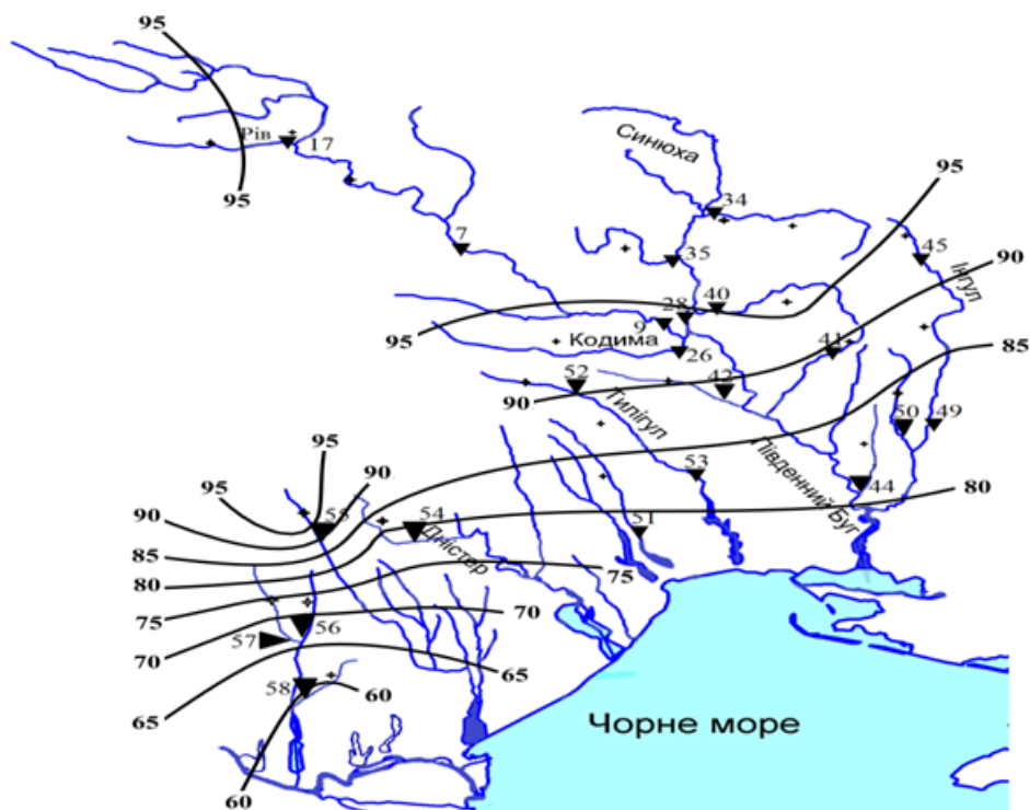
Рис. 3.12 – Карта-схема забезпеченості (P,%) максимальних витрат води весняного водопілля в басейні р. Південний Буг у 2017-2018р.
