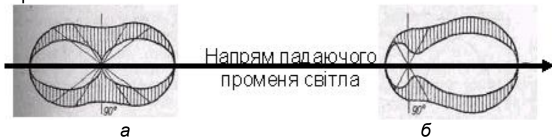
Мал. 7.7. Діаграми Мі, які характеризують розсіяння і поляризацію світла частинками малих (а) і великих (б) розмірів.
