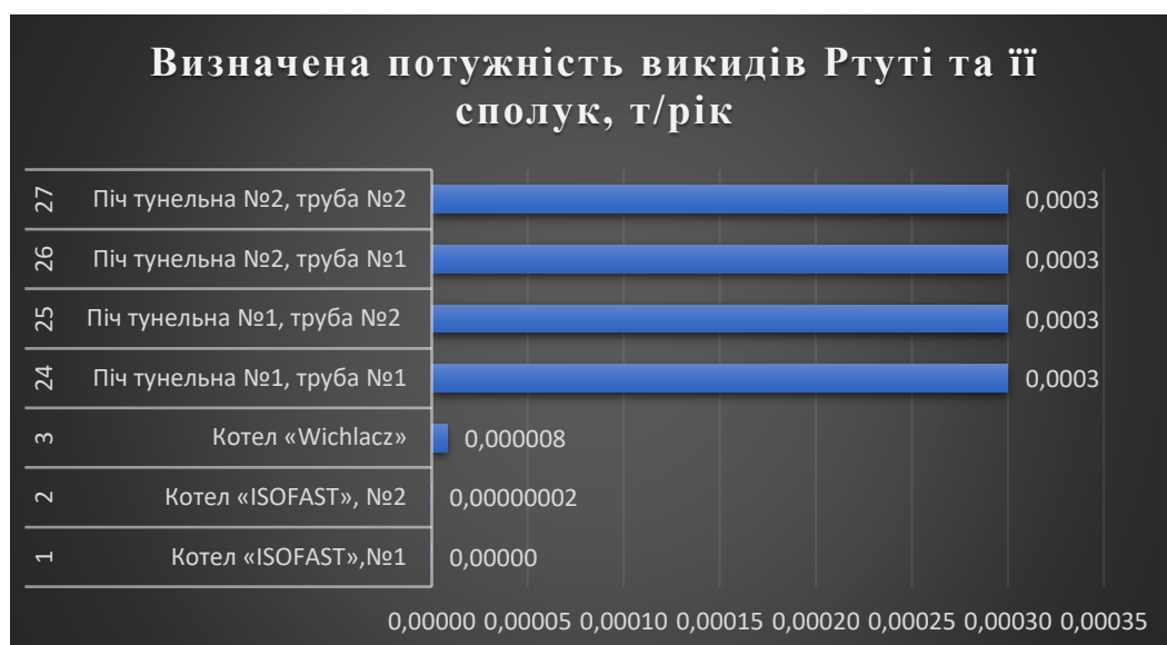
Рис. 3.9 – Потужність викидів ртуті та її сполук від джерел забруднення атмосферного повітря ТОВ«КЗБМ №1».
