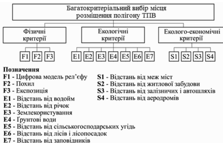
Рисунок 4.13 – Ієрархія критеріїв для багатокритеріальної задачі розміщення полігону ТПВ
