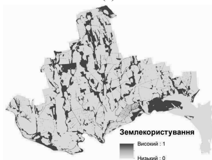
Рисунок Б.2 – Растри функцій належності, отримані при розрахунку придатності територій для розміщення полігонів ТПВ на півдні Одеської області: відстань від дорожньої мережі (а), відстань від населених пунктів (б), землекористування (в), глибина залягання ґрунтових вод (г)
