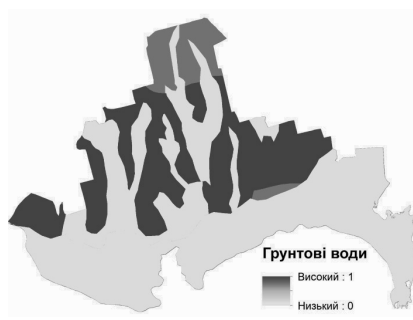
Рисунок Б.2 – Растри функцій належності, отримані при розрахунку придатності територій для розміщення полігонів ТПВ на півдні Одеської області: відстань від дорожньої мережі (а), відстань від населених пунктів (б), землекористування (в), глибина залягання ґрунтових вод (г)
