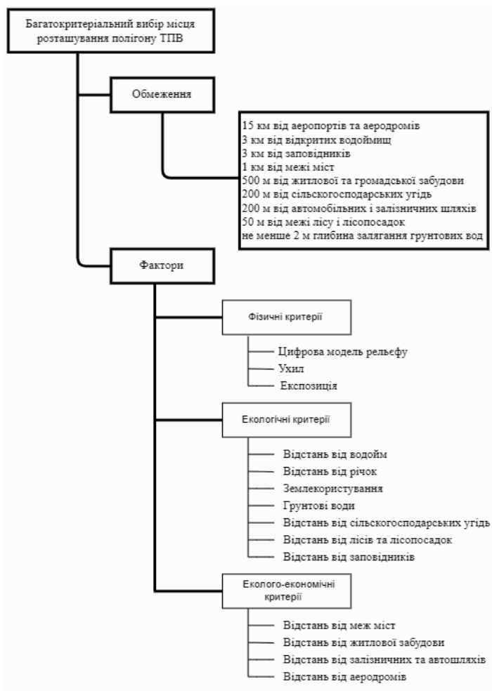
Рисунок 4.8 – Ієрархія прийняття рішень для багатокритеріальної задачі розміщення полігону ТПВ
