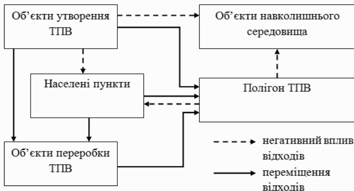
Рисунок 4.6 – Схема взаємодії об'єктів утворення, перероблення та розміщення ТПВ
