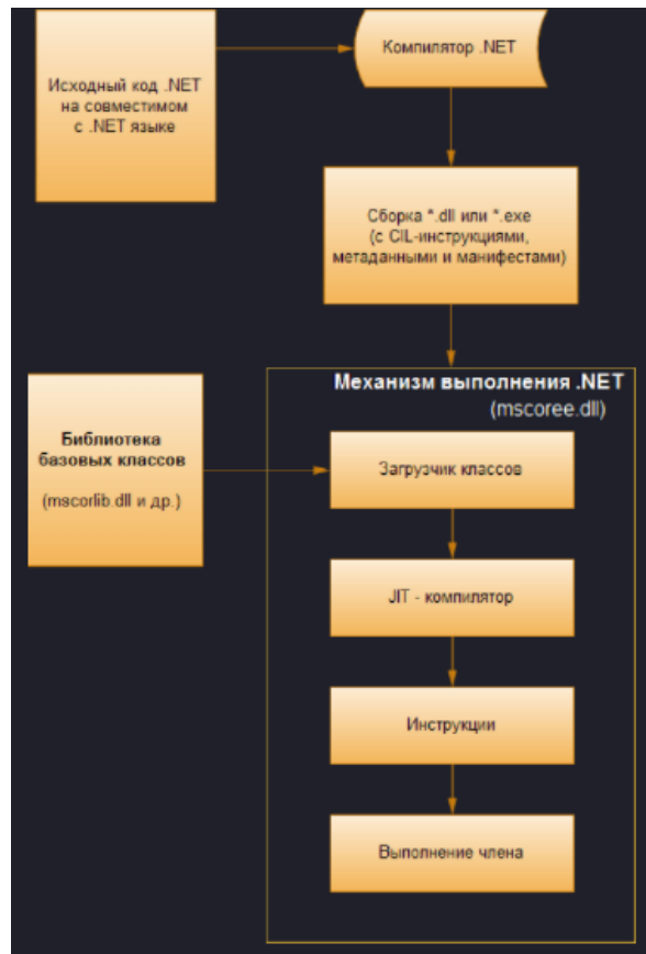
Рисунок 7 – Взаємодія компілятора та механізму виконання .NET
