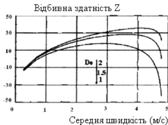
Рисунок 1.6 – Змодельований спектр доплерівських частот для різних значень
