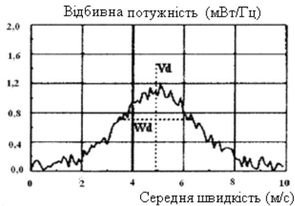
Рисунок 1.5 – Типовий спектр доплерівських швидкостей
