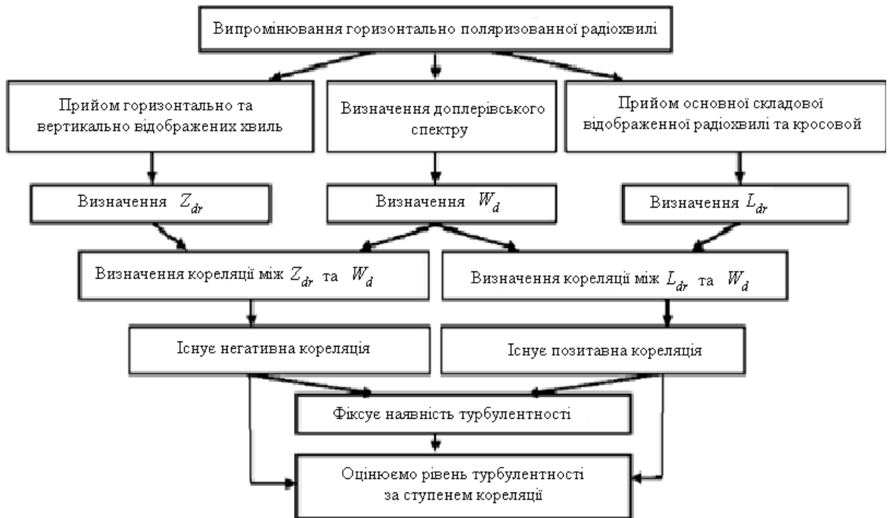
Рисунок 1.22 – Визначення міри турбулентності
