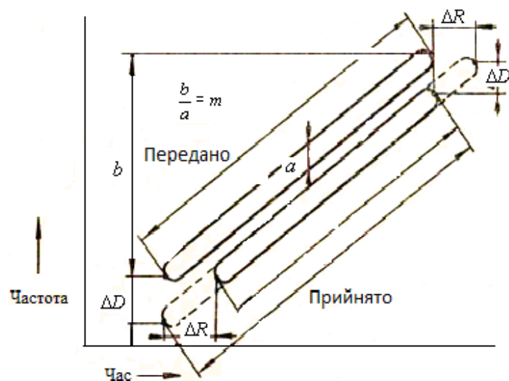
Рисунок 2.8 – Лінійна частотна модуляція з доплерівським зсувом частоти \Delta D і «еквівалентним» зсувом за дальністю \Delta R
