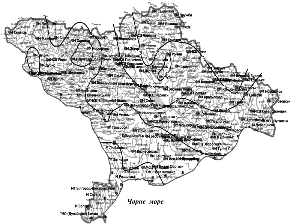
Рис. 5.8. Розподіл по території середньобагаторічних величин максимальних глибин промерзання ґрунтів, см.
