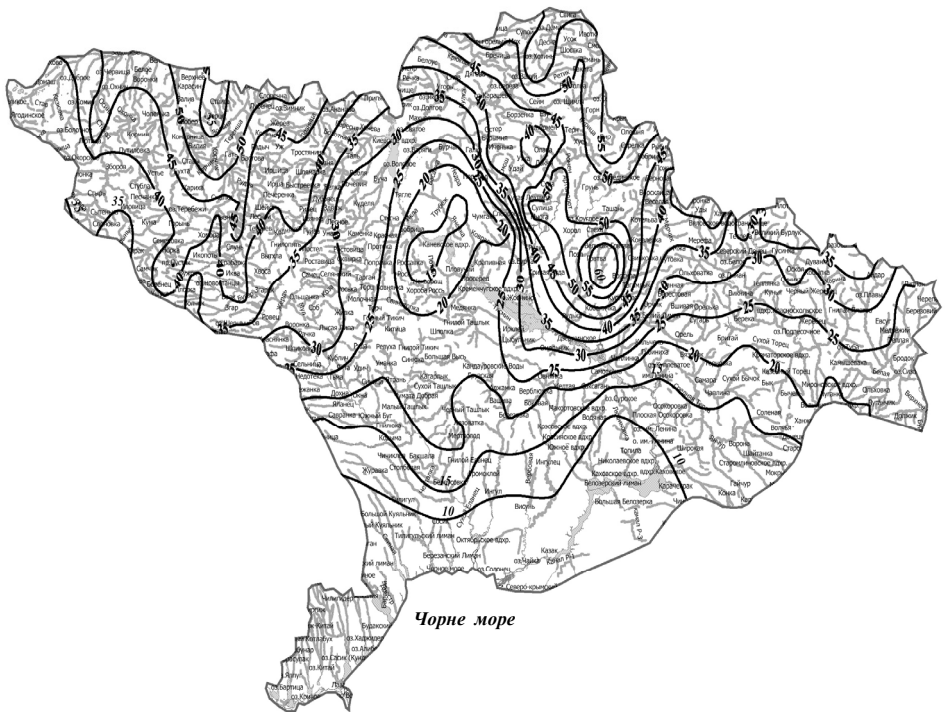
Рис. 4.3. Розподіл по території середньобагаторічних величин шарів стоку весняного водопілля (при f_{\lambda} = 0 , f_{\delta} = 0 ) в басейнах річок рівнинної території України, мм
