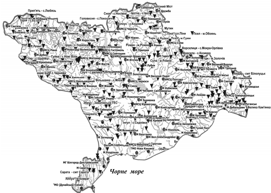
Рис. 1.21. Гідрометеорологічна мережа спостережень в басейнах рівнинних річок України: ▼ – гідрологічний пост; ● – метеорологічна станція
