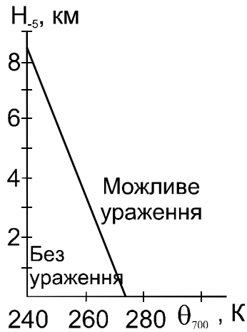
Рис. 7.3. Графік для прогнозу небезпечних електричних зон в шарувато-подібних хмарах та опадах при байдужій стратифікації атмосфери.
