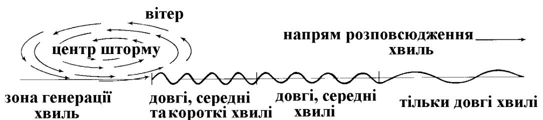
Рис. 6.13 Схема виникнення та розповсюдження вітрових хвиль; перетворення вимушених хвиль у вільні (зиб).
