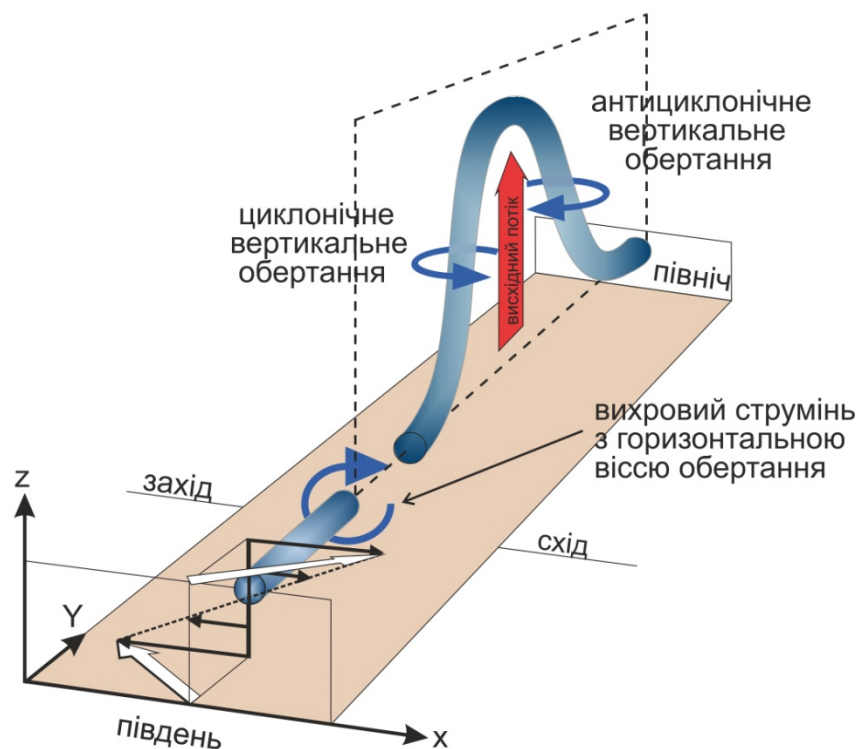
Рисунок 37 – Протилежні напрямки обертання в мезоциклоні, сформованого конвективним висхідним потоком з горизонтальною віссю обертання, яка зумовлена вертикальним зсувом вітру. Синій циліндр позначає вихрову вісь
