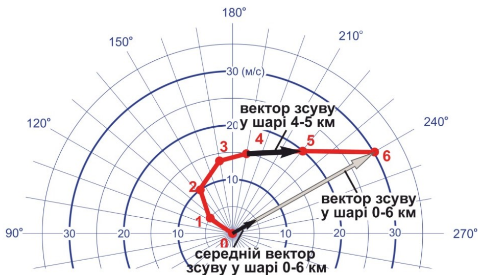
Рисунок 48 – Приклад визначення середнього вектору зсуву між рівнями 0 та 6 км (показаний маленькою чорною стрілкою). На рисунку представлені 6 шарів по 1 км кожний, що дає можливість використовувати «сурогат» зсуву вітру – різницю між швидкостями вітру
