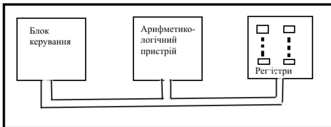
Рисунок 3.1 Схема устрою центрального процесора
