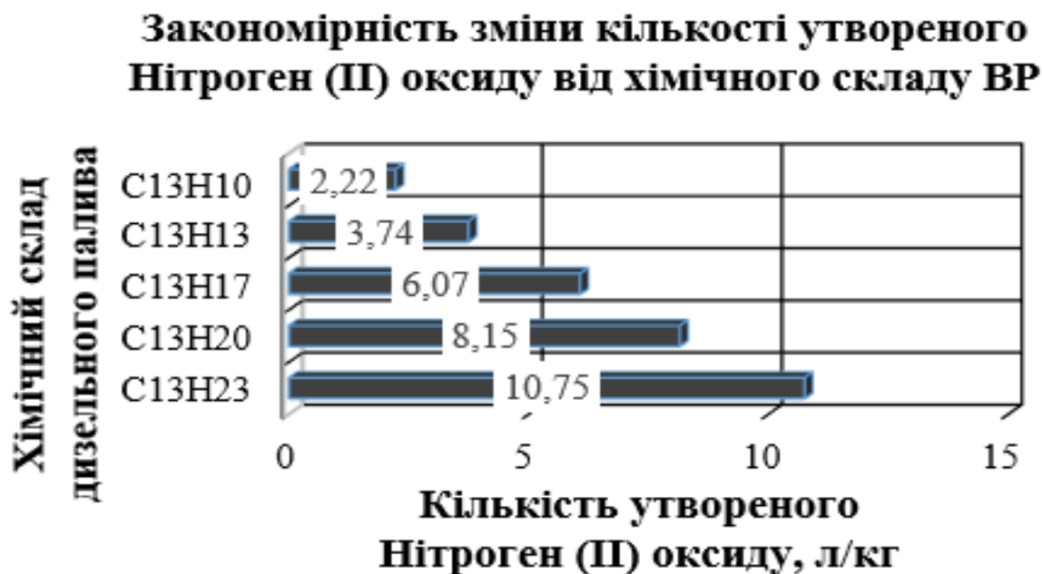
Рис. 3.3 – Закономірність зміни кількості утвореного Нітроген (II) оксиду під час вибуху від хімічного складу дизельного палива у вибуховій речовині
