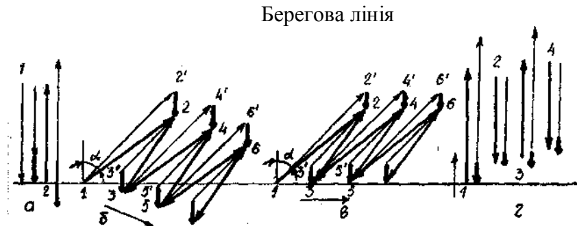
Рисунок 1. Схема донного вздовжберегового переміщення наносів: а - фронтальний підхід хвиль, рівновага досягнута; б - хвилі тих же параметрів розвернулись на кут \alpha = 45^\circ , наноси переміщуються під кутом до берега в бік моря; в - рівновага досягнута при новій системі хвиль; г - хвилі знову розвернулись по нормалі при новому, більш похилому схилі - наноси переміщуються до берега; товста стрілка - вектор сили тяжіння; тонка стрілка вектор гідродинамічної сили; наведена стрілка - їх рівнодіюча; стрілки під схемами - напрямком переміщення наносів; а - кут підходу хвиль до берега; 1,2,3,... - положення часток на відкосі.
