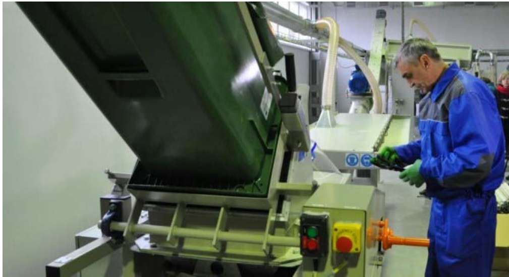
Рисунок 3.2 – Робота устаткування з переробки ламп шведської компанії MRT System International
