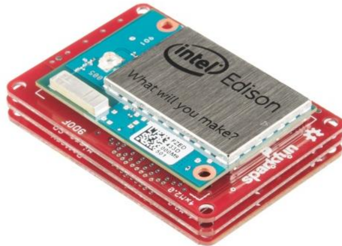
Рисунок 1.2 – Зовнішній вигляд пристрою Intel Edison
