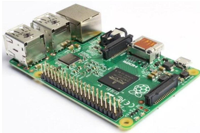
Рисунок 1.3 – Зовнішній вигляд пристрою Raspberry Pi 2 Model
