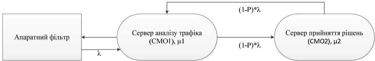
Рисунок 5.2 – Спрощена аналітична модель системи DPI
