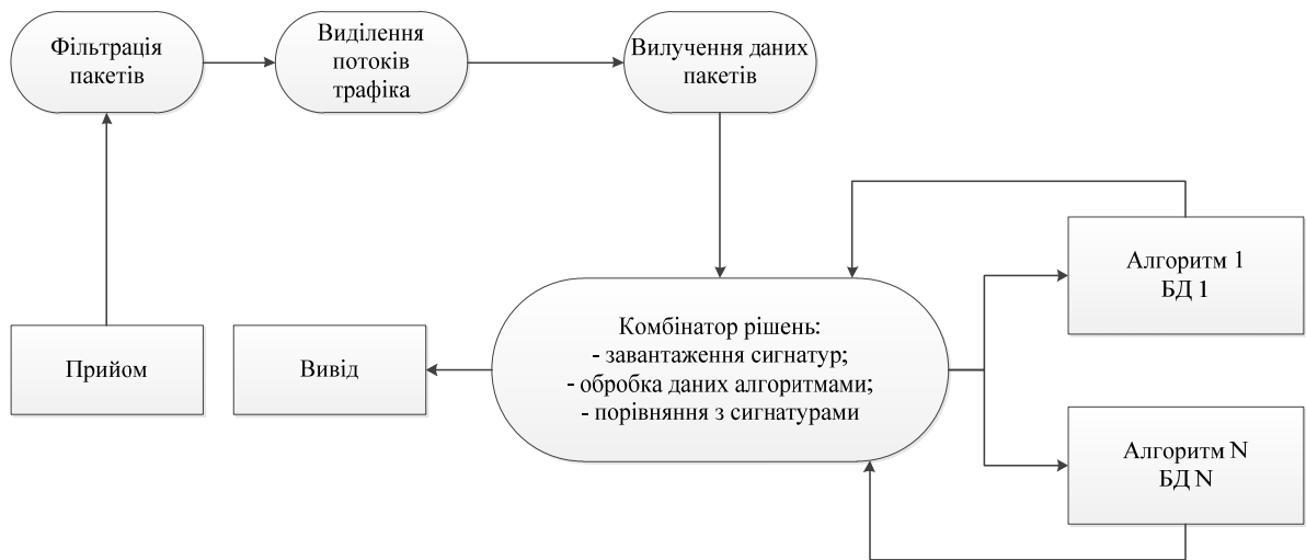
Рисунок 5.1 – Аналіз пакетів DPI з використанням комбінатора рішень
