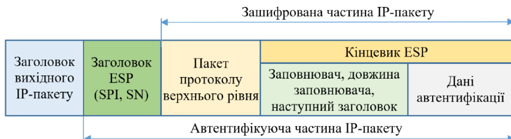
Рисунок 7 – Структура IP-пакету, обробленого протоколом ESP в транспортному режимі
