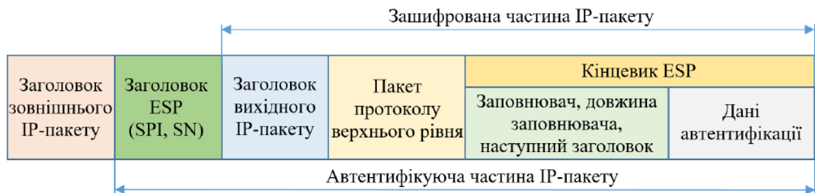
Рисунок. 8 – Структура IP-пакету, обробленого протоколом ESP в тунельному режимі
