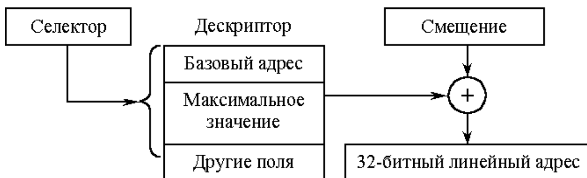
Рисунок 14 – Перетворення пари (селектор, зміщення) на лінійну адресу
