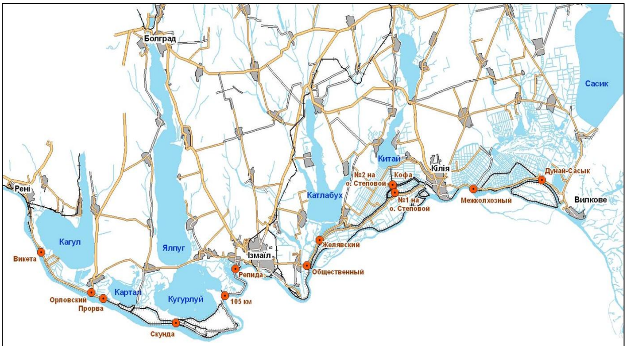
Рисунок 2.1. Схема розташування шлюзів-регуляторів на Придунайських водосховищах
