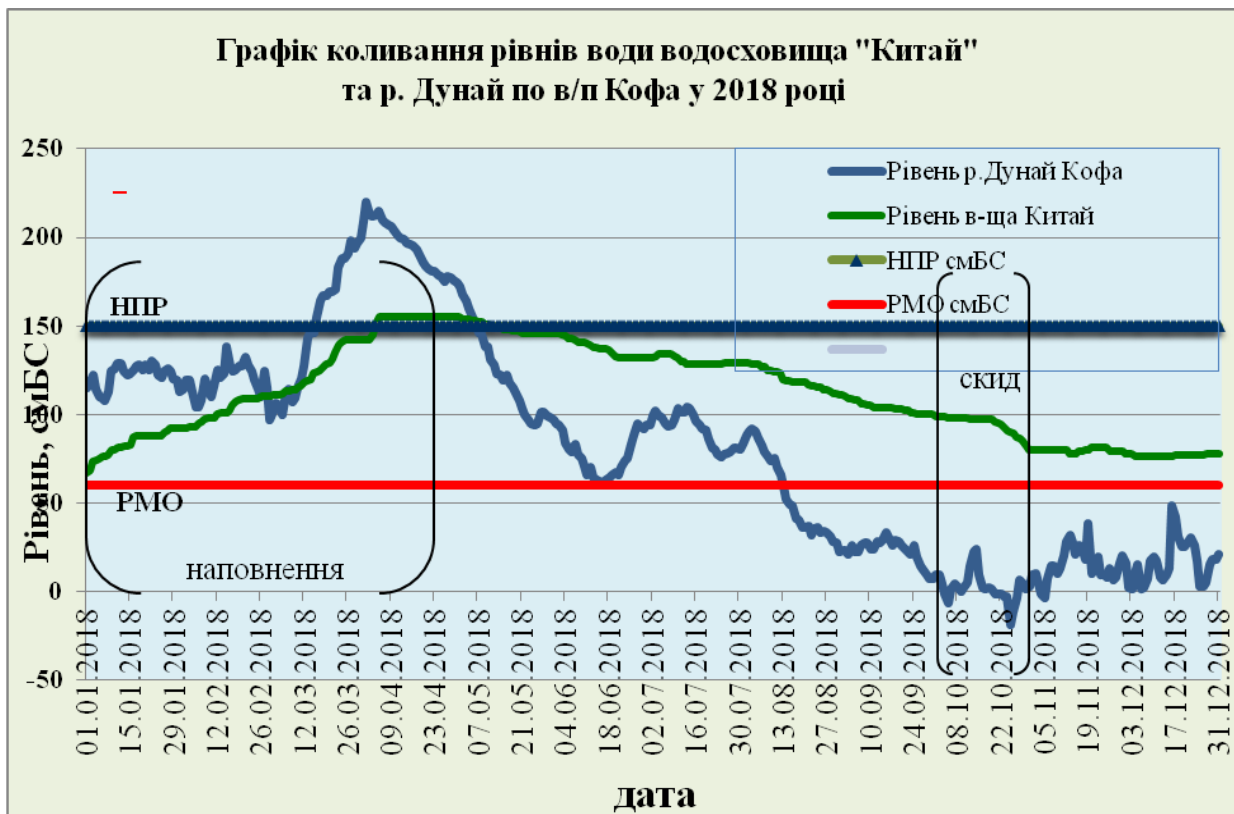
Рисунок 2.2. Графік наповнення та спрацювання озера Китай у 2018 р[8].
