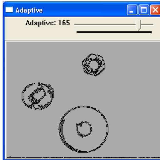
Рисунок 10 – Застосування адаптивної порогової функції
