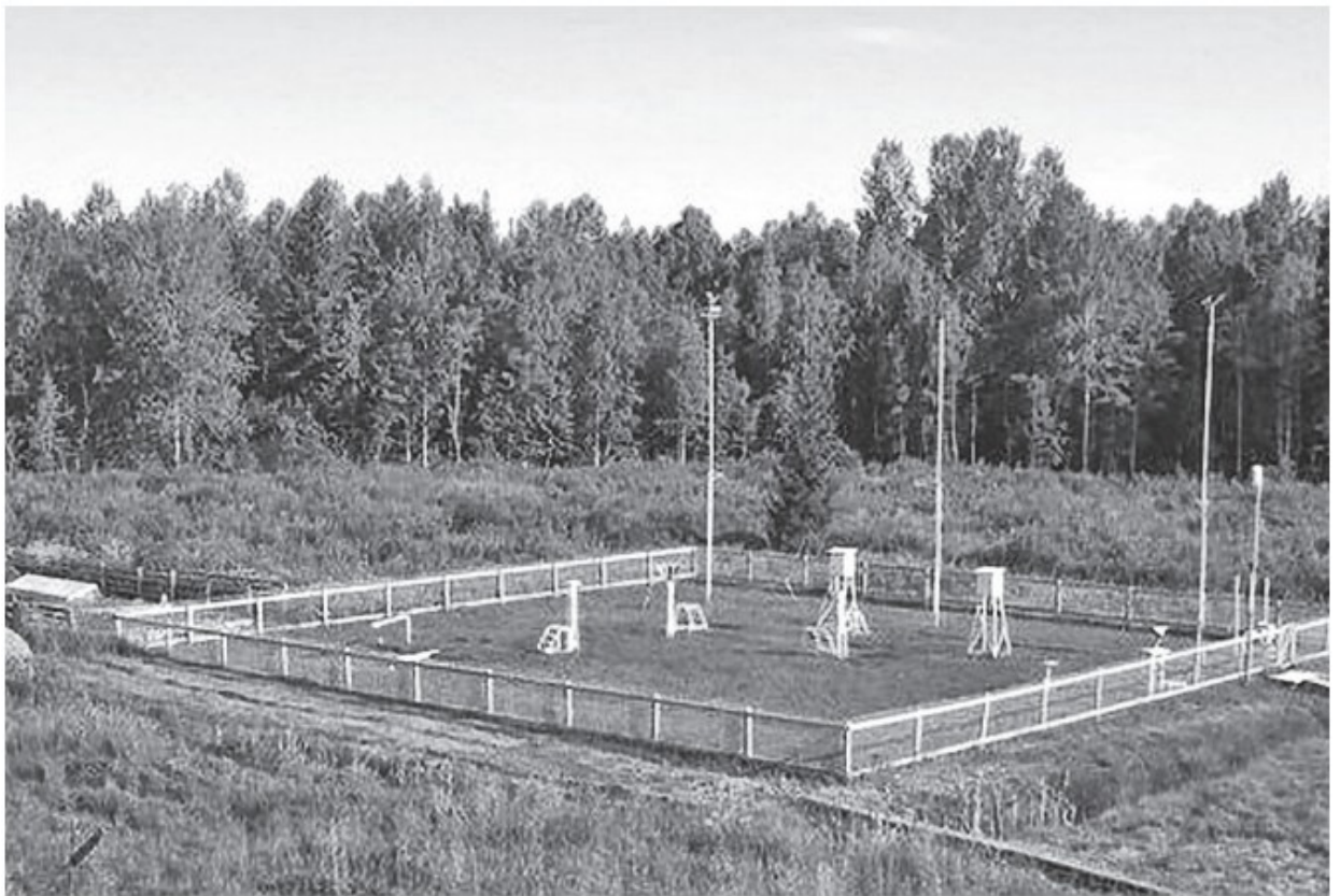
Рисунок 1.4 - Наземна метеорологічна станція загального призначення АМС загального призначення – автоматична інформаційно-вимірювальна система «Погода»
