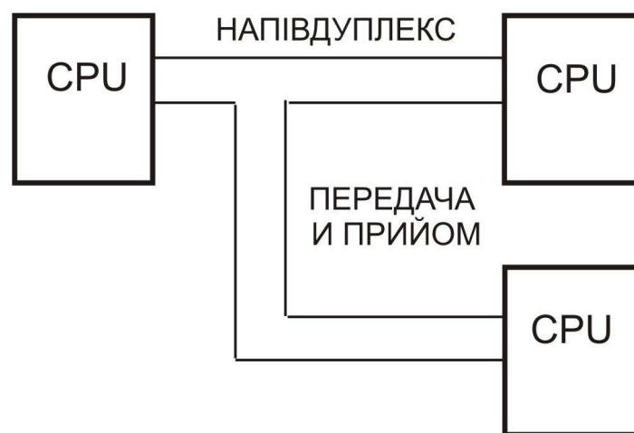
Рисунок 7.12 – Схема двоспрямованої передачі даних і напівдуплексного зв'язку в інтерфейсі RS-485
