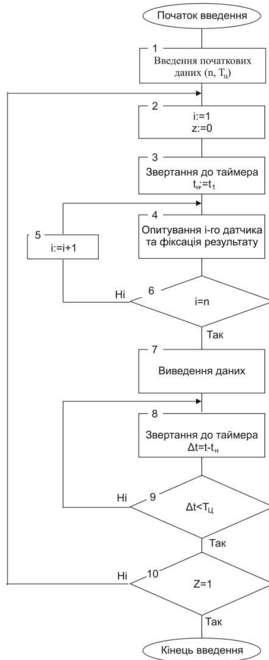
Рисунок 9.2 – Схема алгоритму циклічного опитування датчиків (2-й етап)
