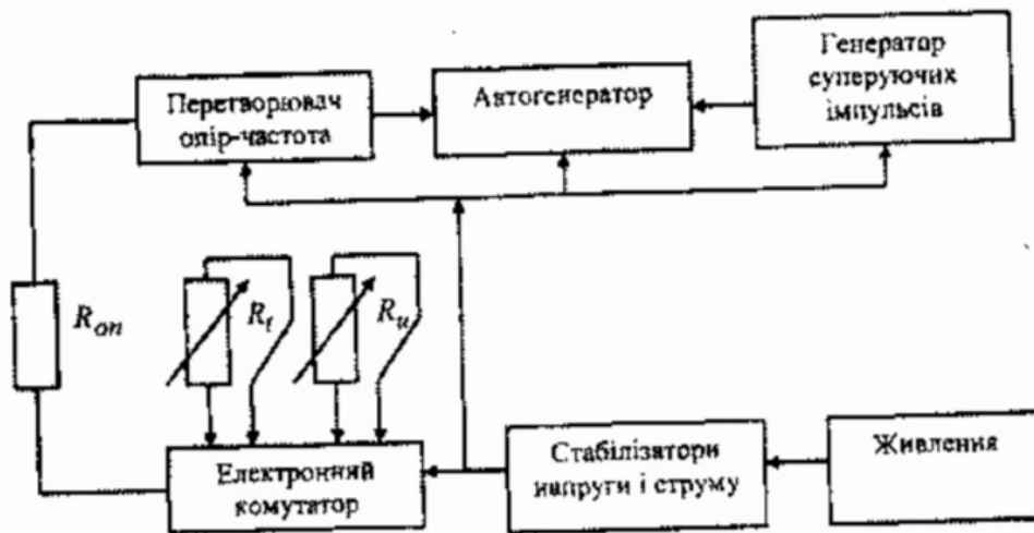
Рис.2.1 -Блок-схема радіозонда типу МАРЗ: R_{on} - резистор опорної частоти; R_t - резистор температурної частоти; R_u - резистор частоти вологості.
