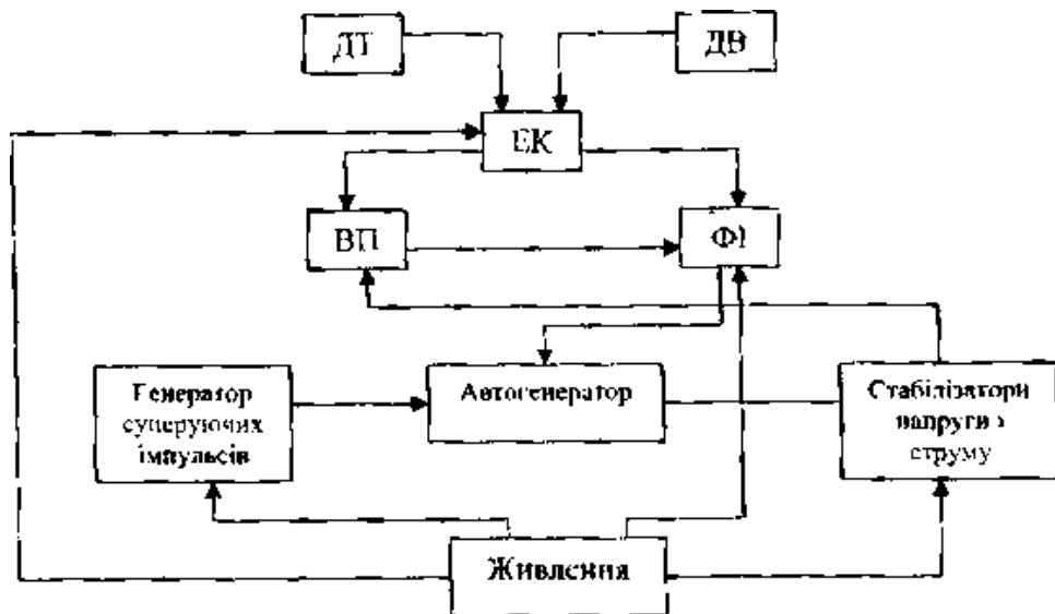
Рис.2.2 - Структурна схема радіозонда МРЗ-3А.
