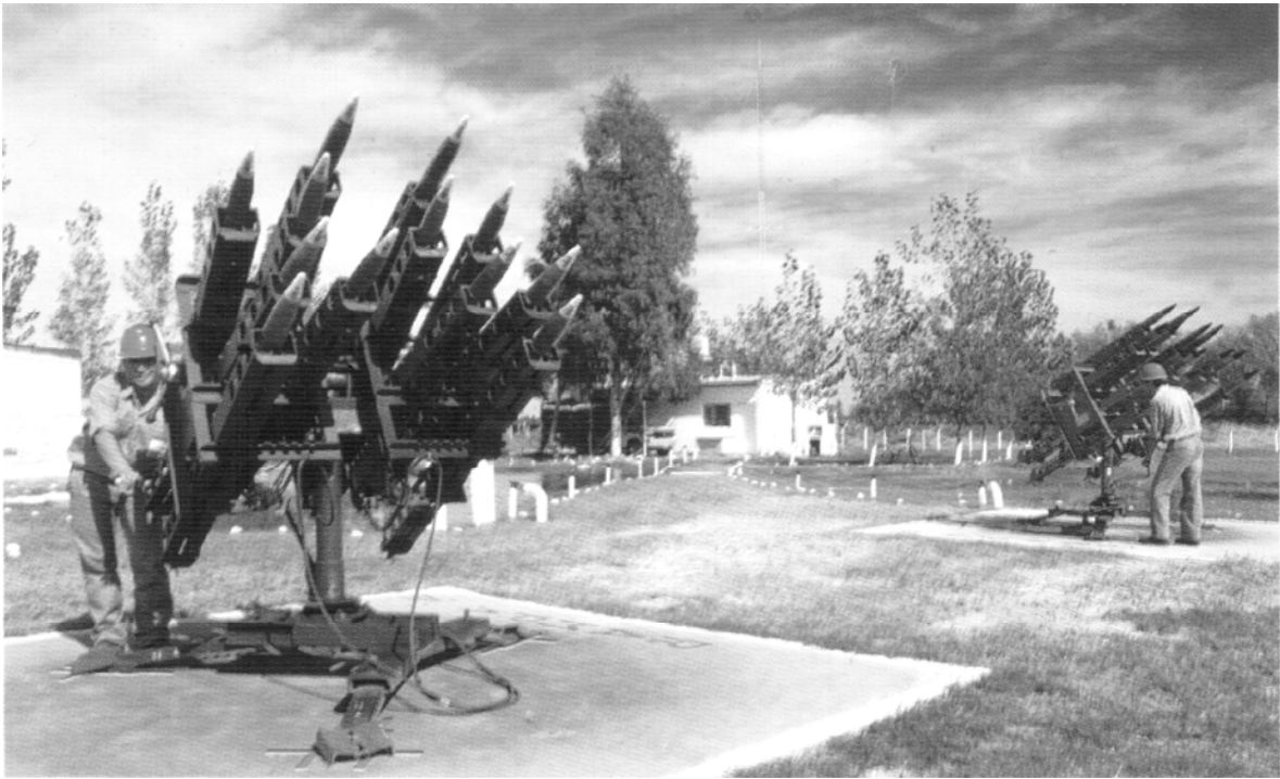
Рисунок 3.4 – Направляючі комплексу пускової установки
