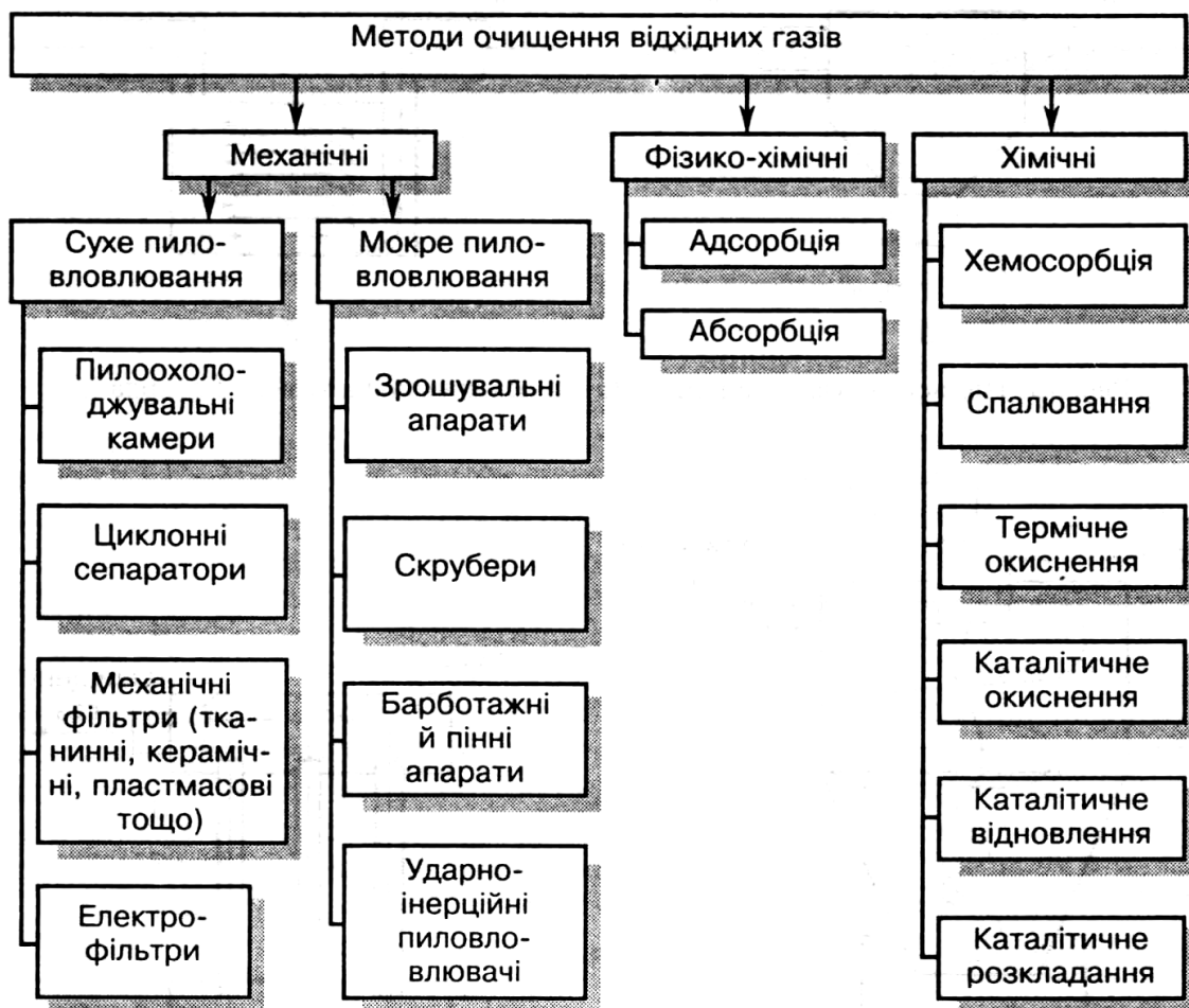
Рис. 2.2 – Схема методів очищення відхідних газових викидів
