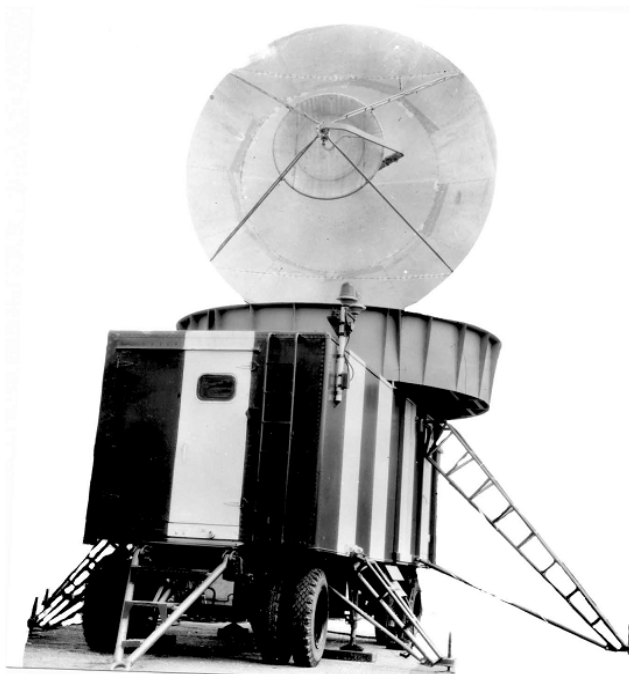
Рисунок 1.2 - Зовнішній вигляд МРЛ-5 без вітрозахисного покриття (варіант А)
