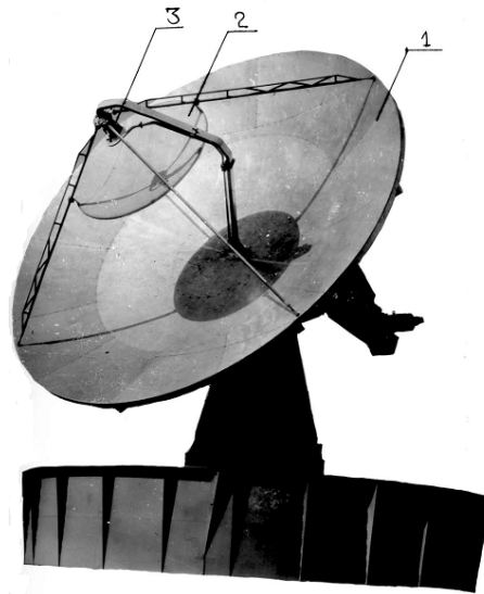
Рисунок 2.1 - Загальний вигляд антени: 1 - відбивач; 2 - відбивач; 3 - опромінювач
