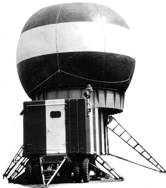
Рисунок 1.1 - Зовнішній вигляд МРЛ-5 із вітрозахисним покриттям (варіант А)
