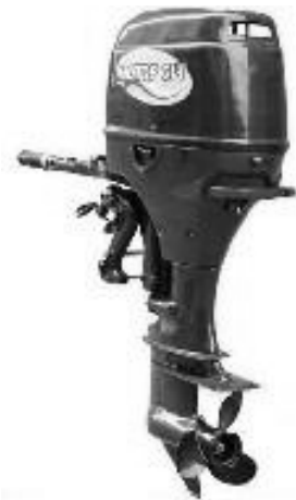
Підвісний човновий бензиновий двигун "Мотор-Січ", потужність 40 к.с. (29,4 кВт)
