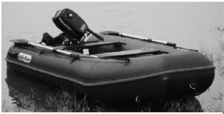
Надувний човен класу Roll Up, виготовлений з армірованого ПВХ
