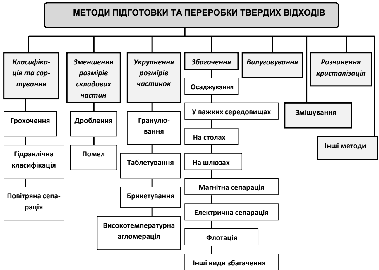
Рис. 3.1 – Методи підготовки та переробки твердих відходів.
