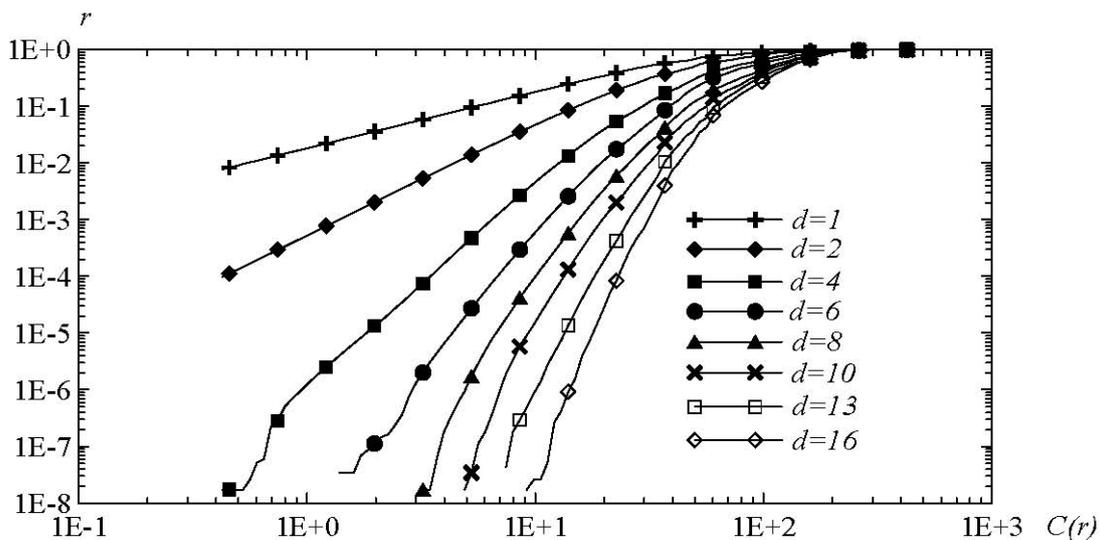
Рис. 3. Взаимосвязь между корреляционным интегралом  $C(r)$  и радиусом  $r$  для разных размерностей вложения  $d$  для метана.
