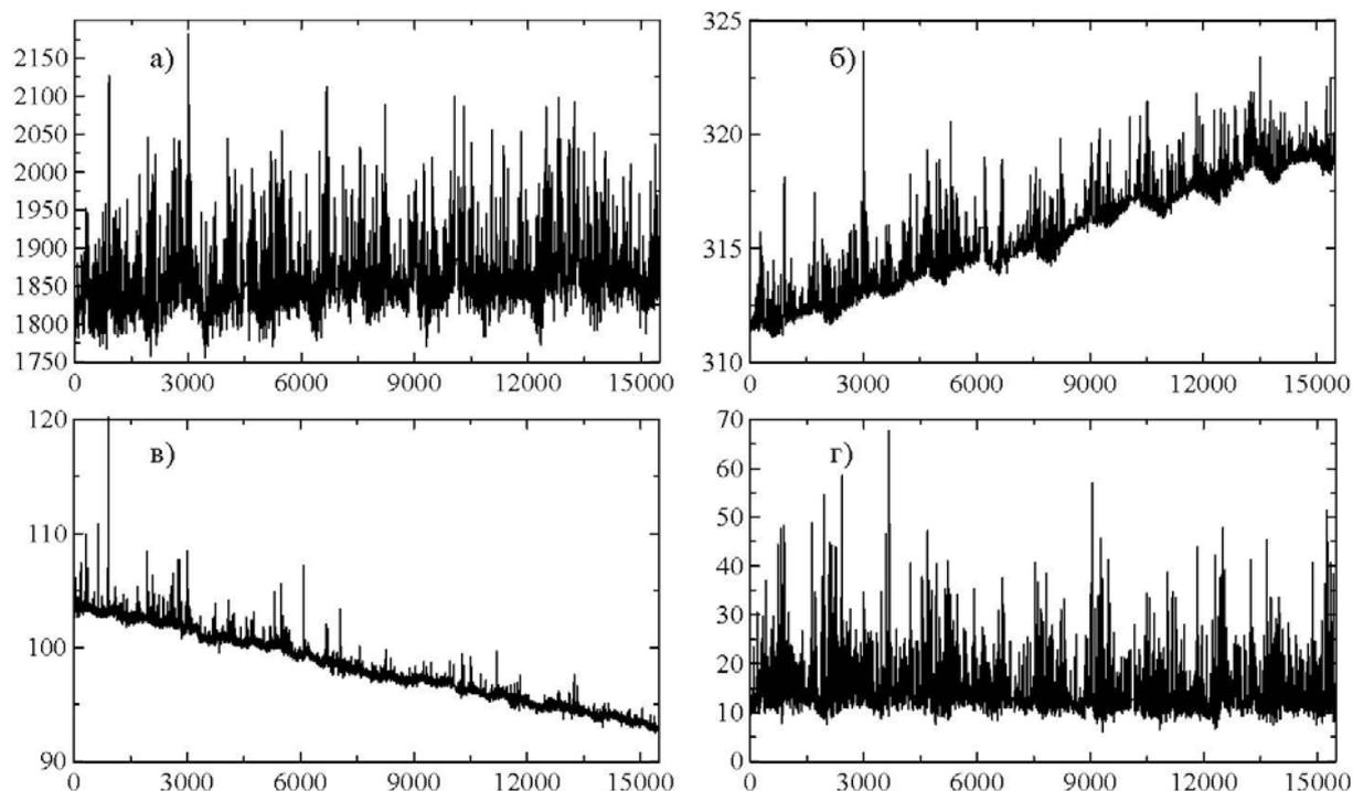
Рис. 1. Концентрации метана (а), двуокиси азота (б), тетрахлорида углерода (в) и хлороформа (г) на станции Мейс Хед за период с 03.03.94 по 30.09.04. Для  $\text{CH}_4$  и  $\text{N}_2\text{O}$  концентрации даны в  $10^{-9}$ , для  $\text{CCl}_4$  и  $\text{CHCl}_3$  – в  $10^{-12}$ . Метки на оси X – порядковые номера элементов ряда.
