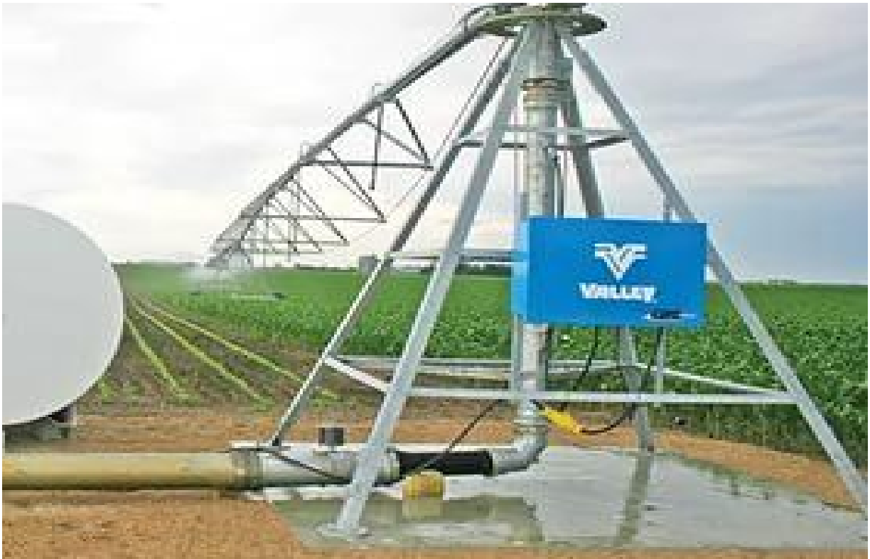
Рис. 1.2 – Центральна нерухома опора ДМ «Фрегат»
