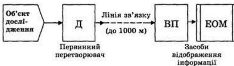
Рис.21 Схема дистанційної передачі сигналів вимірювальної інформації
