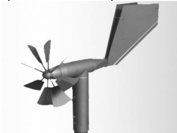
Рис. 17 - Конструкція флюгарки з крильчаткою.
