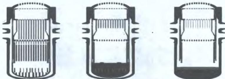
Рис. 2.37. Фазы развития тяжелой аварии для реактора ВВЭР-1000. Расчеты по коду СОКРАТ-В1.
