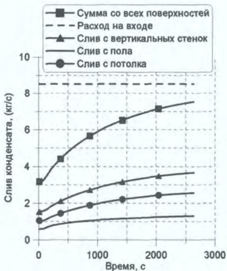
Рис. 2.67. Эволюция удельного потока конденсата.
