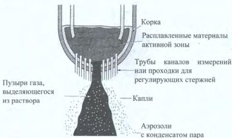
Рис. 2.16. Механизмы выброса расплава при высоком давлении [81].
