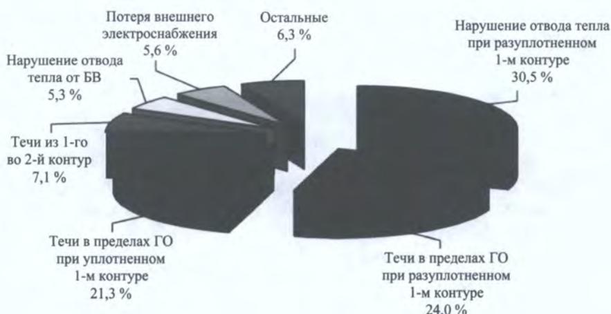
Рис. 1.17. Распределение вкладов ИС в частоты повреждения активной зоны и топлива в БВ.
