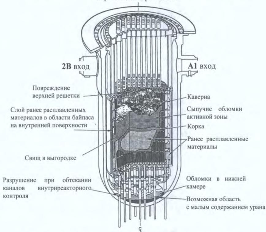
Рис. 2.6. Конфигурация финального состояния активной зоны.
