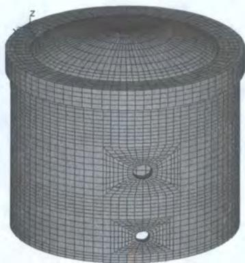
Рис. 1.8. Трехмерная конечноэлементная модель ЗО АЭС с ВВЭР-1000, которая включает 113006 объемных восьмиузловых конечных элементов и 122316 узлов.
