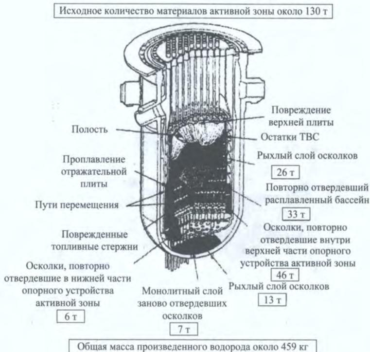
Рис. 2.40. Окончательная конфигурация активной зоны реактора ТМІ-2 и распределение материалов в ней.
