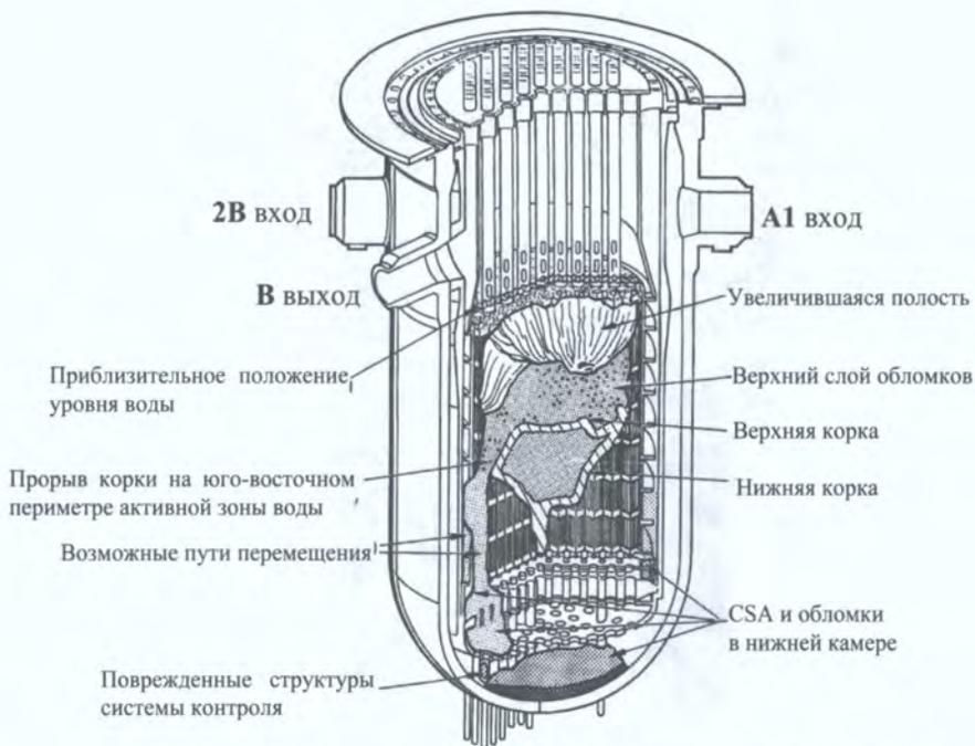
Рис. 2.5. Предполагаемая конфигурация активной зоны во время перемещения расплава.
