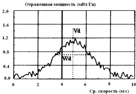
Рис. 5 – Типичный спектр доплеровских скоростей
