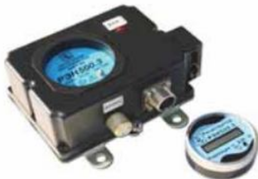
Рис. 3.10. Лічильник-реєстратор для обліку витрат електроенергії тяговими електродвигунами
