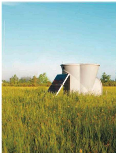
Рисунок 5.1 - Трипроменевий содар TRITON має висоту зондування 200м
