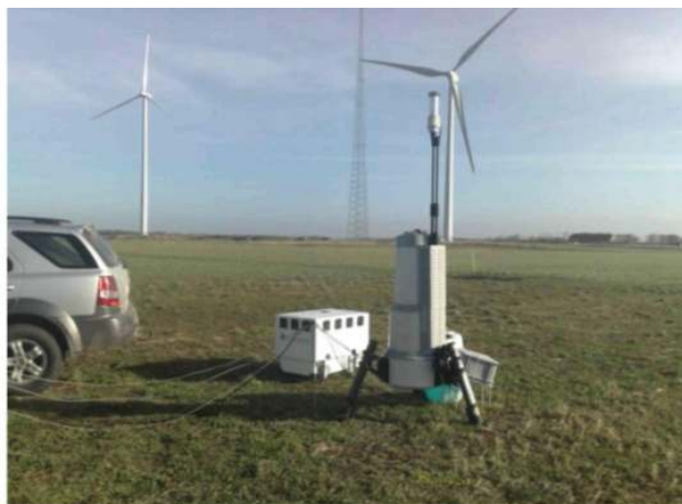
Рисунок 5.2 Ліворуч - вітровий цілком волоконний профайлер Windcube- фірми LEOSPHERE і праворуч Qineti/NaturalPowerZephIR
