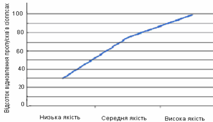
Рисунок 4.12 – Залежність калманівської фільтрації від якості вхідного зображення
