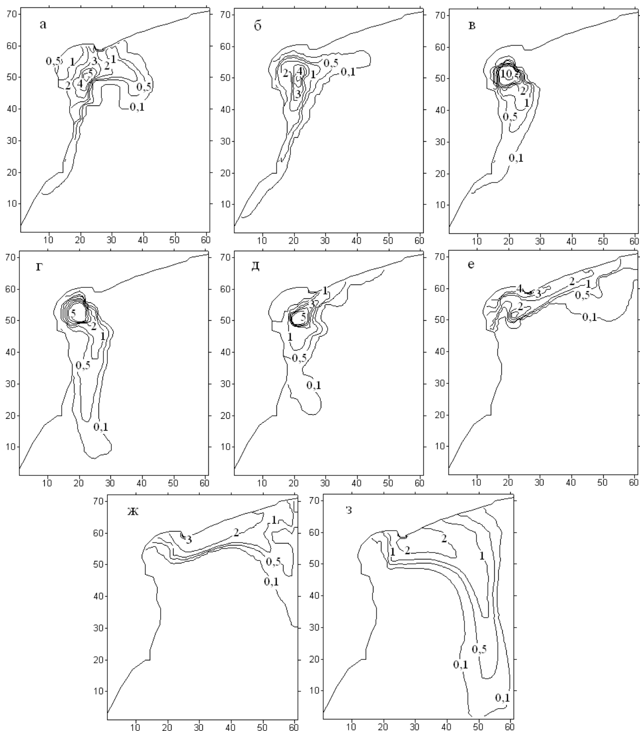
Рис. 4.12 – Концентрация консервативной примеси нейтральной плавучести (загрязняющего вещества) в поверхностном слое при функционировании СБО «Северная» ( проектируемый вариант ) при ветрах разных направлений со скоростью 7 м/с: а) северный; б) северо-восточный; в) восточный; г) юго-восточный; д) южный; е) юго-западный; ж) западный; з) северо-западный.
