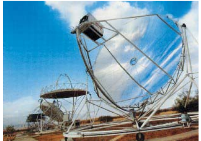
Рис.3.11 - Сонячна установка тарілкового типу: а – схема сонячної установки тарілкового типу; б – сонячна установка потужністю 10 кВт на сонячній електростанції в Almeria (Іспанія)
