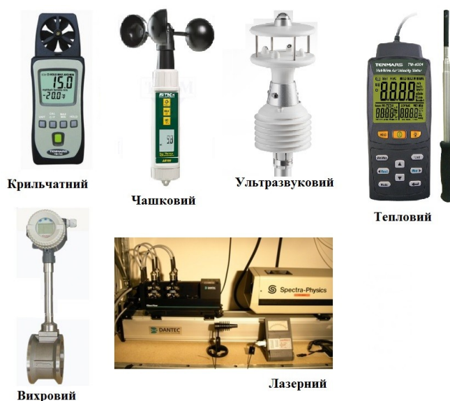
Рисунок 3.1 – Класифікація датчиків в залежності від способу вимірювання та типу приймального пристрою
