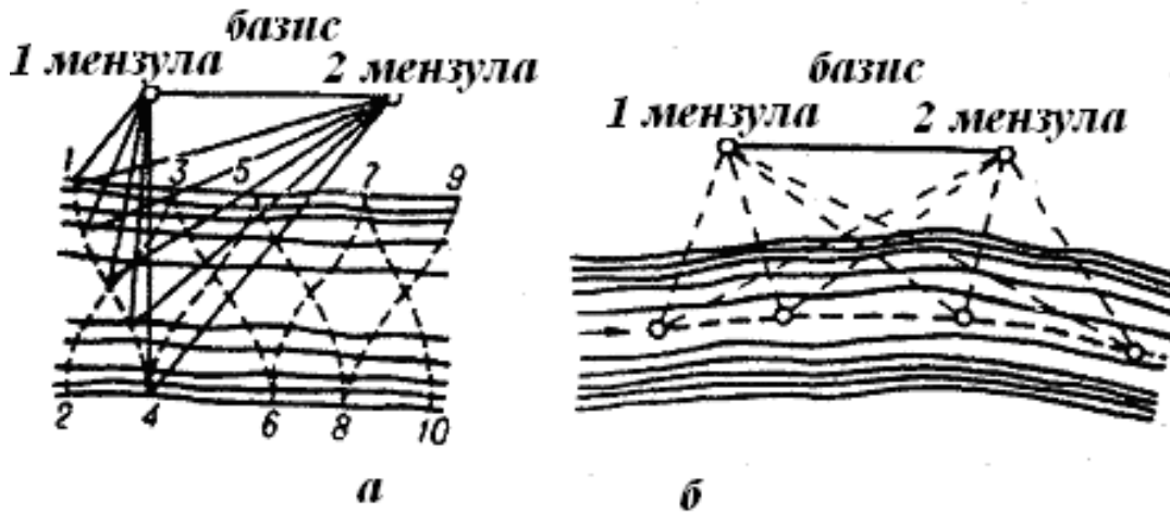
Рисунок 2.4 – Проміри: а) косими галсами; б) по повздожникам
