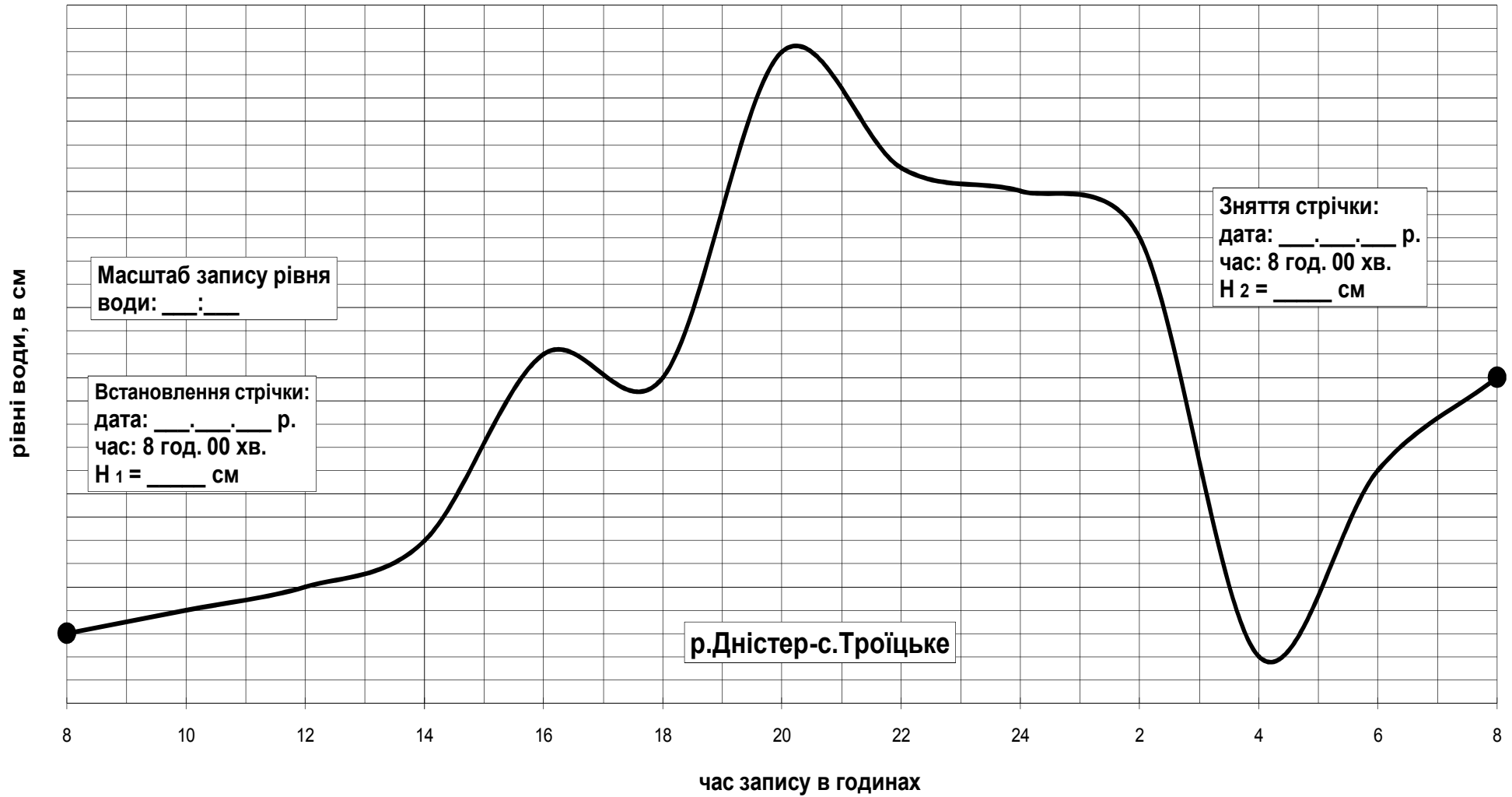
Рисунок А.2 – Запис добового ходу рівня води на стрічці СРВ “Валдай”, р. Дністер – с. Троїцьке
