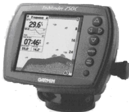
Рисунок 2.7 – Електронний ехолот «Fishfinder-250» («Garmin»)
