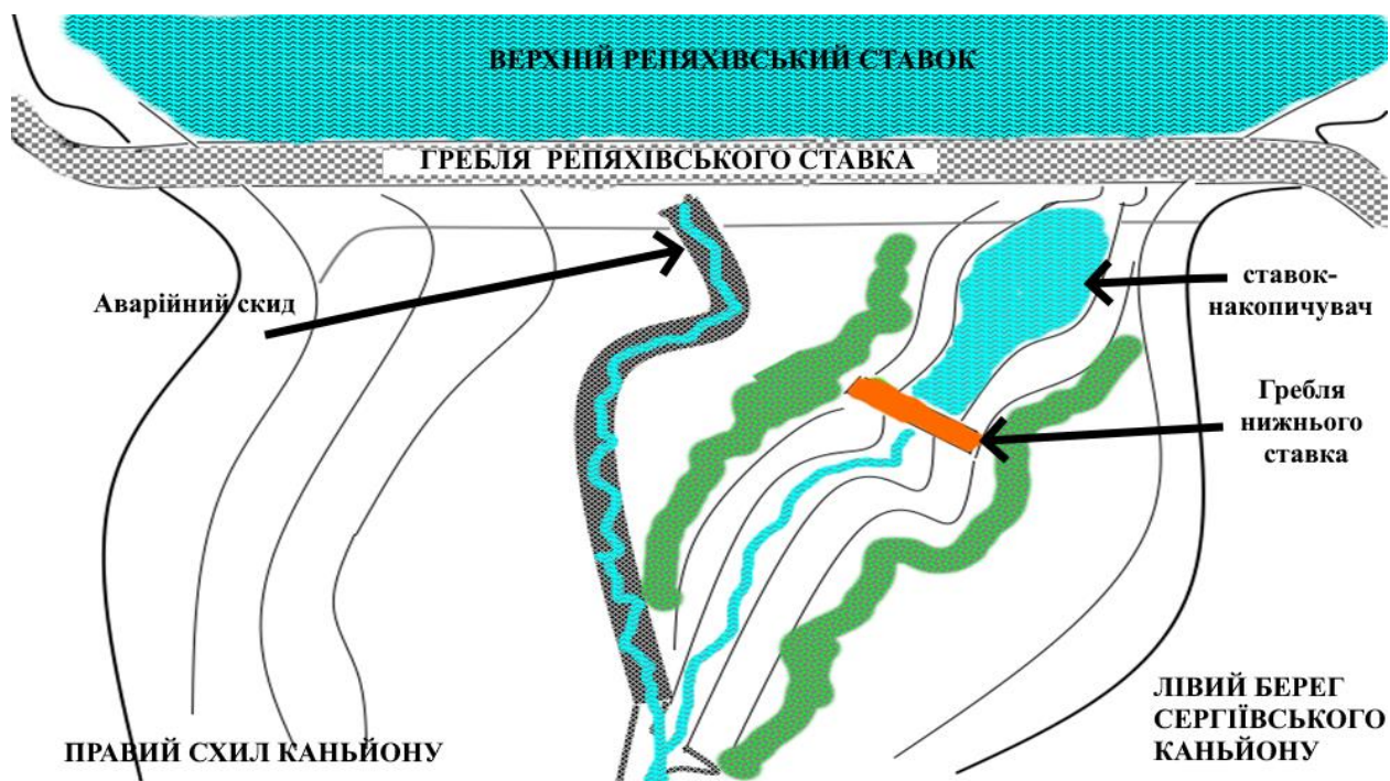
Рисунок 4.4 – Верхній та нижній ставки та їх водоскиди в межах Сергіївського каньйону (за автором)
