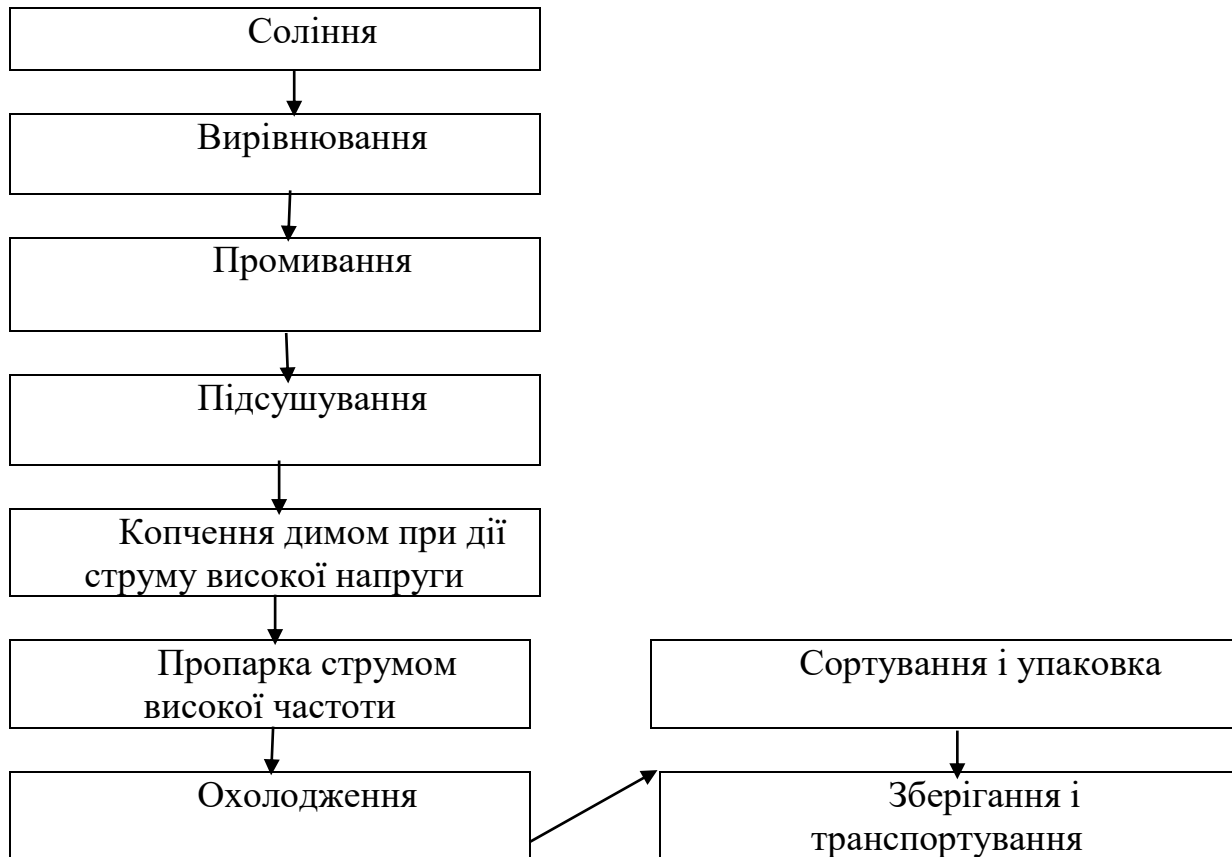
Рисунок 6.6 – Технологічна схема електрокопчення риби
