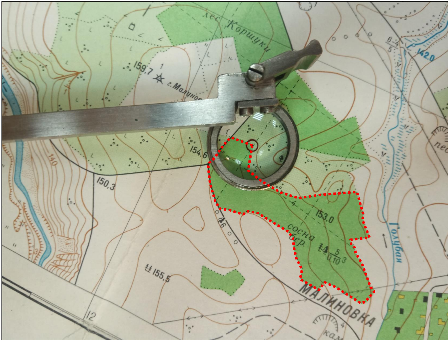
Земельна ділянка на топографічній карті масштабу 1:10 000 для визначення площі полярним планіметром
