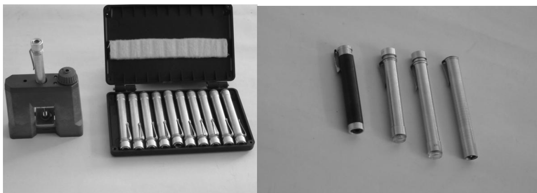
Рисунок 3.2 Загальний вигляд приладів індивідуального дозиметричного контролю: а – зарядний пристрій ЗД-6; б – комплект індивідуальних дозиметрів ДК-02; в – дозиметр КІД-1; г – дозиметр ДК-02; д - дозиметр ДКП-50; е – дозиметр ІД-1.
