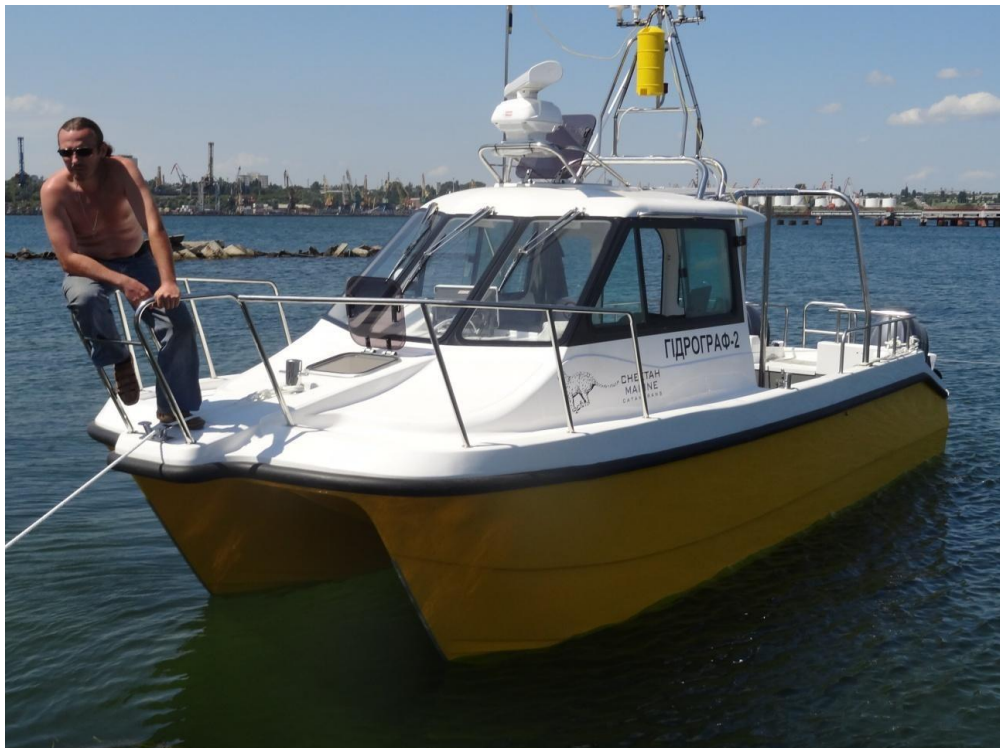
Рисунок 10.4 – Промірний катер-катамаран «Гідрограф-2»
