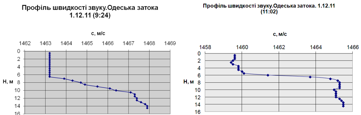
Рисунок 10.1– Зміна профілю швидкості звуку за період часу менше двох годин
